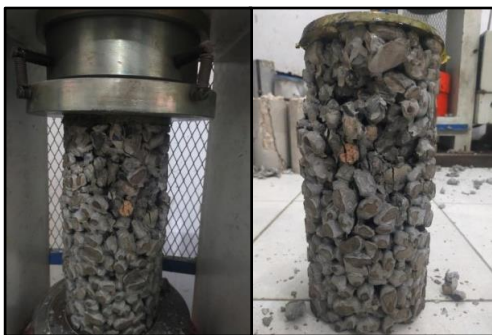
Gambar 4. Uji kuat tekan beton berongga
