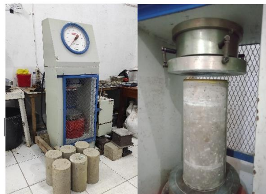
Gambar 2. Pengujian benda uji dengan mesin uji kuat tekan beton
